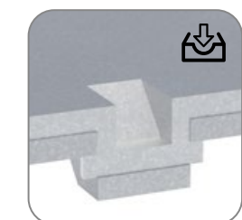
Клинчинг - надежный метод соединения лонжерона и поперечины
