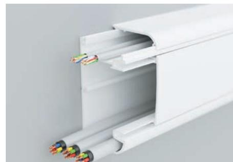
Уникальная конструкция: в короб 90/2×50 мм (код 09500) встроен разделитель, создающий 2 независимых отсека с крышками для удобной прокладки различной проводки. Разделитель имеет преперфорацию, при необходимости кабель можно перенести из одной секции короба в другую
