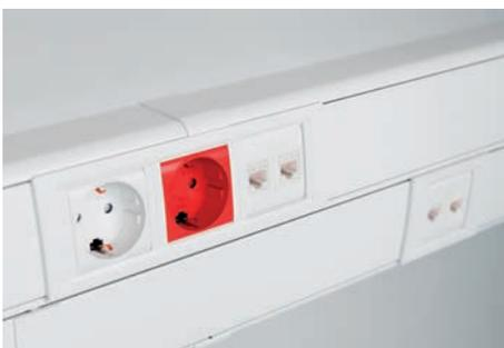
Короб 140×50 мм с одной широкой крышкой можно использовать как магистральный. Короб 140×50 мм с двумя узкими крышками можно использовать как электроустановочный. Разделитель имеет преперфорацию для перехода кабеля из одной секции в другую. Во все короба можно установить ЭУИ серии "Avanti", "Viva" и УЭИ размером 45×45 мм
