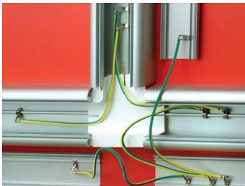
Проводом заземления (код E0001C) соедините крышку третьего короба с первым, к которому была прикреплена клемма провода (код E0001B). Защёлкиванием установите клеммы провода (код E0001C) на направляющие, расположенные на внутренних сторонах крышек.
