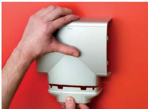
При отводе от трассы коробов 140x50 мм короба 90x50 мм вставьте в декоративную накладку тройника переходник 140-90x50 (код 01408G). При отводе короба 110x50 вставьте переходник 140-110x50 (код 01010G).
