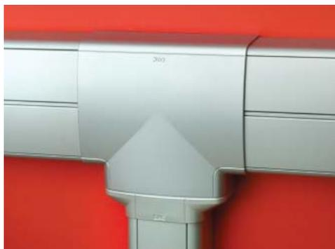
Защелкиванием установите накладку на тройник. Затем крышки коробов сдвиньте в сторону тройника или переустановите их заново, чтобы они зашли под накладку.
